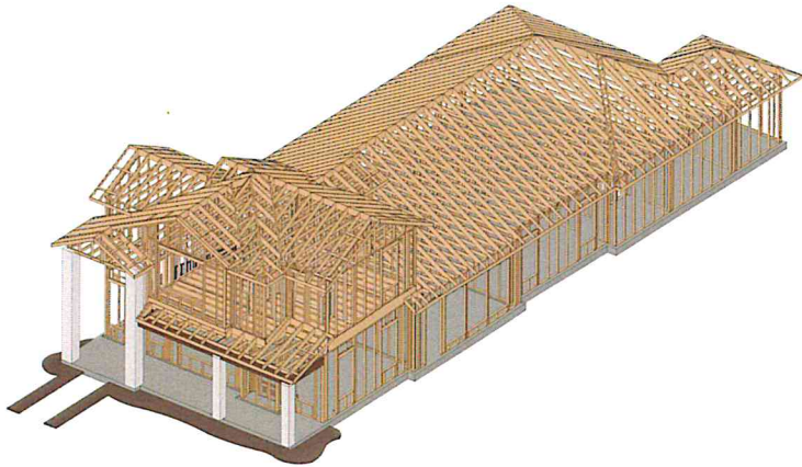
2 FRAMING OVERVIEW SCALE: N.T.S.
